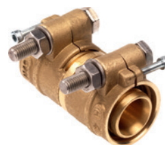
PE-X x PE-X Samlemuffe med fastsiddende støttebøsning og to udvendige spænderinge SDR 11 - Varme - HC
