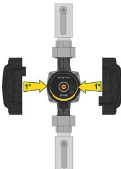
Rysunek 7: Izolacja korpusu pompy
