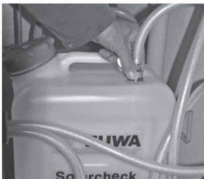
2. Montera returslangen på behållaren
