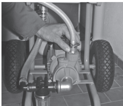
1. Tryckslang anslutas till pumpens utlopp
