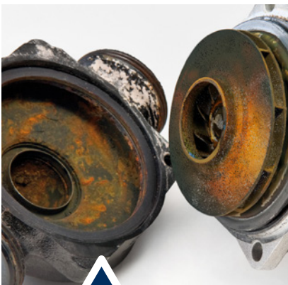
De magnetiske felter, som er dannet af pumperne, tiltrækker etalrester, hvilket kan forringe enhedens ydeevne.
